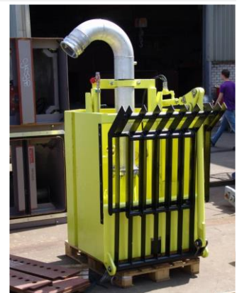
Fig.3 Weir Skimmer Module
