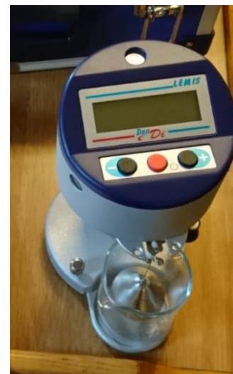
Fig.33 Density meter
